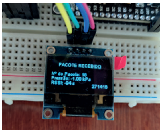
Figura 12. Circuito recebendo leituras do circuito transmissor.
