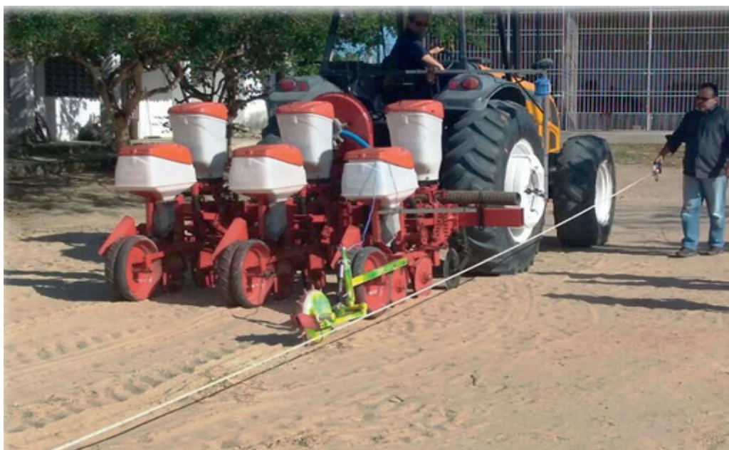
Figura 3. Roda odométrica acoplada à semeadora-adubadora
